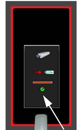
Attendre l'apparition du pictogramme vert et le fonctionnement du buzzer pour retirer la clé
